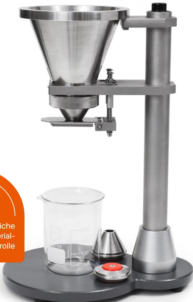
Schlechte Rieseigenschaften eines Kunststoffes können im Trichter der Verarbeitungsmaschine zum Stocken des Materialflusses führen. Die möglichen Folgen sind Qualitätsschwankungen des Endprodukts oder Produktionsunterbrechungen.
