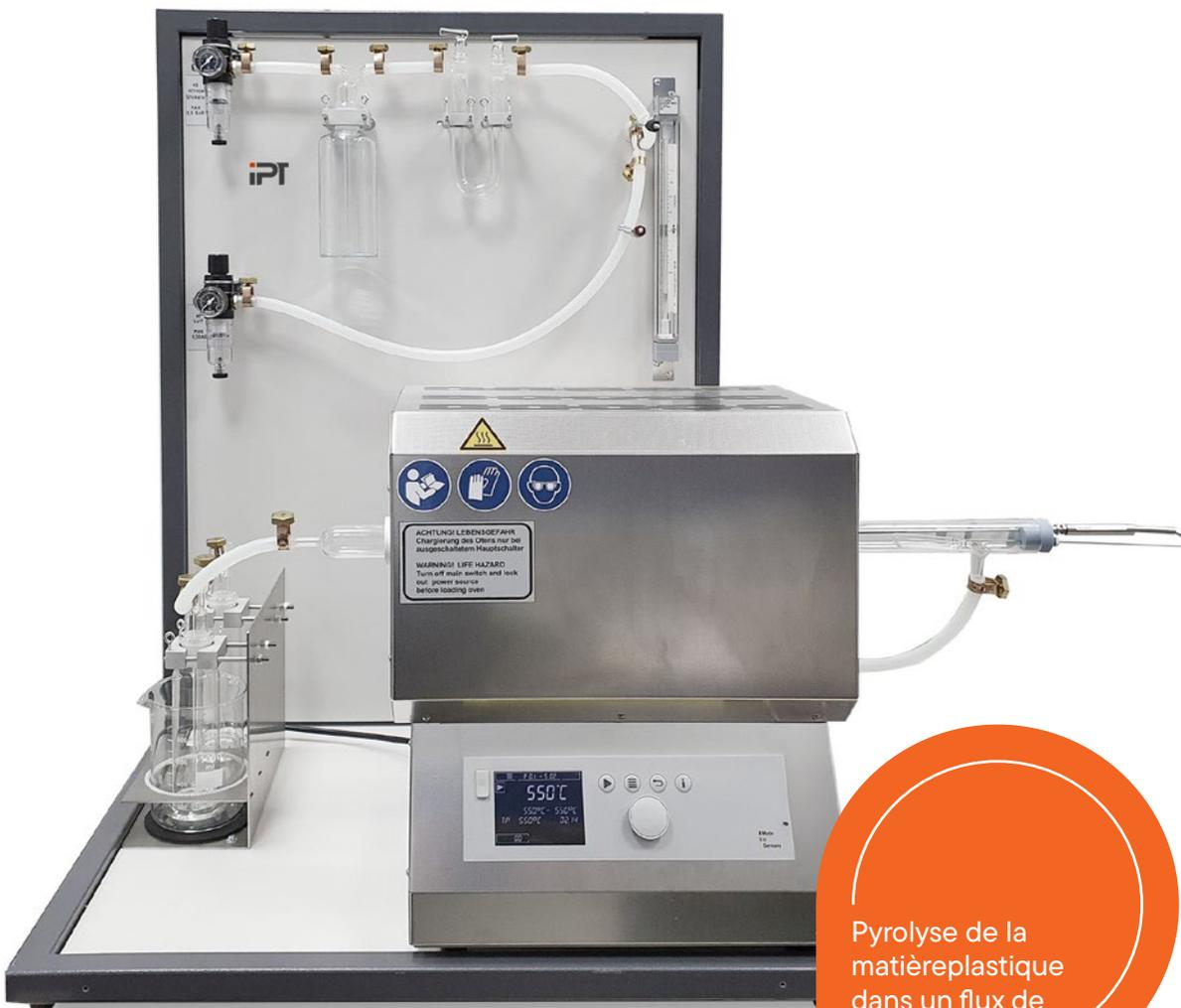
Pyrolyse de la matière plastique dans un flux de gaz inerte
