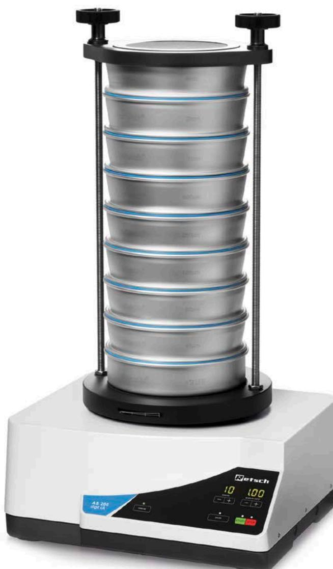
Un mouvement circulaire tridimensionnel est appliqué au matériau à tamiser dans les huit tamis, et le tamisage s'effectue en fonction des prescriptions respectives d'essai ou de la hauteur d'oscillation, de la durée et de l'intervalle défini. Les résultats sont reproductibles à 100 % lors du tamisage à sec. La commande est simple et conviviale. Le
