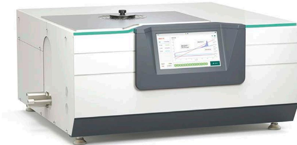
Dynamisches Differenz-Kalorimeter zur Bestimmung der Oxidations-Induktionszeit für Kunststoffrohrleitungs- und Schutzrohrsysteme, sowie Formstücke aus Polyolefinen. Es wird der Zeitraum gemessen, in welchem ein Antioxidationsmittel im Prüfling verbleibt und somit eine Oxidation verhindert. Zur Prüfung wird die Materialprobe bei konstanter, festgelegter Temperatur in strömenden
