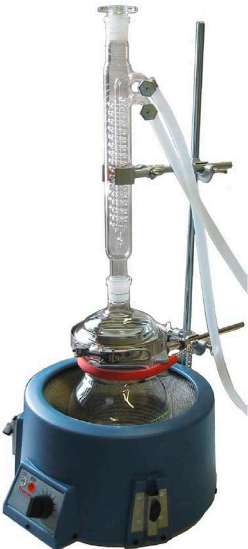
Die ISO 10147 schreibt vor, dass Probekörper aus vernetztem Polyethylen (PE-X) in einem bestimmten, kochenden Prüfmittel über einen festen Zeitraum gelagert werden müssen und anschließend der unlösliche Massanteil gemessen werden muss. Der prozentuale Anteil des unlöslichen Werkstoffes muss als Vernetzungsgrad protokolliert werden. Für diesen Vorgang empfiehlt Ihnen
