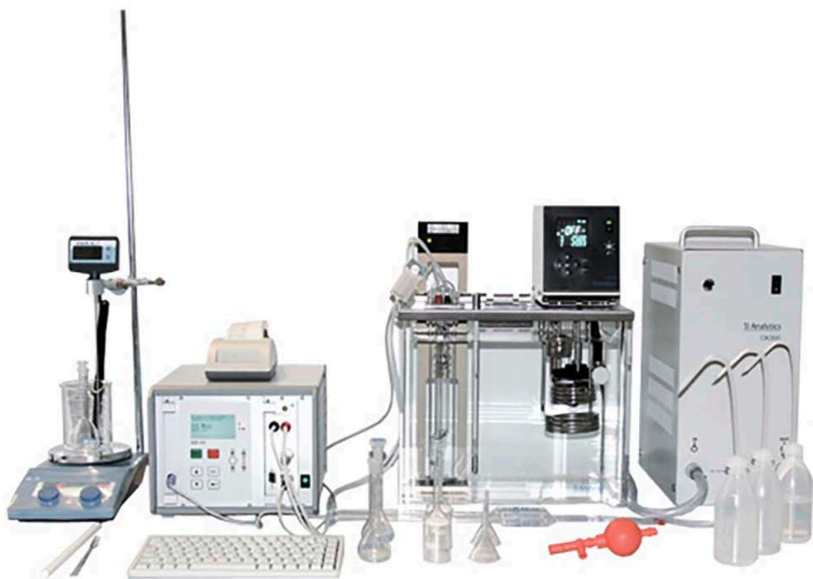
Le set complet de laboratoire pour la détermination de la valeur K comprend un viscosimètre Ubbelohde avec trépied de mesure, l'appareil de mesure de viscosité avec imprimante et un thermostat de bain avec refroidisseur et divers verreries Vous pouvez afficher sur l'écran de mesure jusqu'à 10 mesures automatiques par série de mesures. Les
