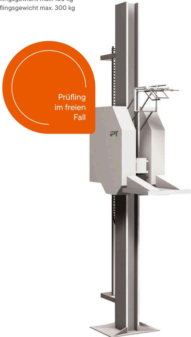
Mit den Fallprüfgeräten von IPT können Verpackungen unterschiedlichster Form und Größe auf Stoßbeanspruchung nach freiem Fall geprüft werden. Die Verpackungen können mit Inhalt geprüft werden und können beispielsweise Kanister, Fässer und Kartons sein. Die
