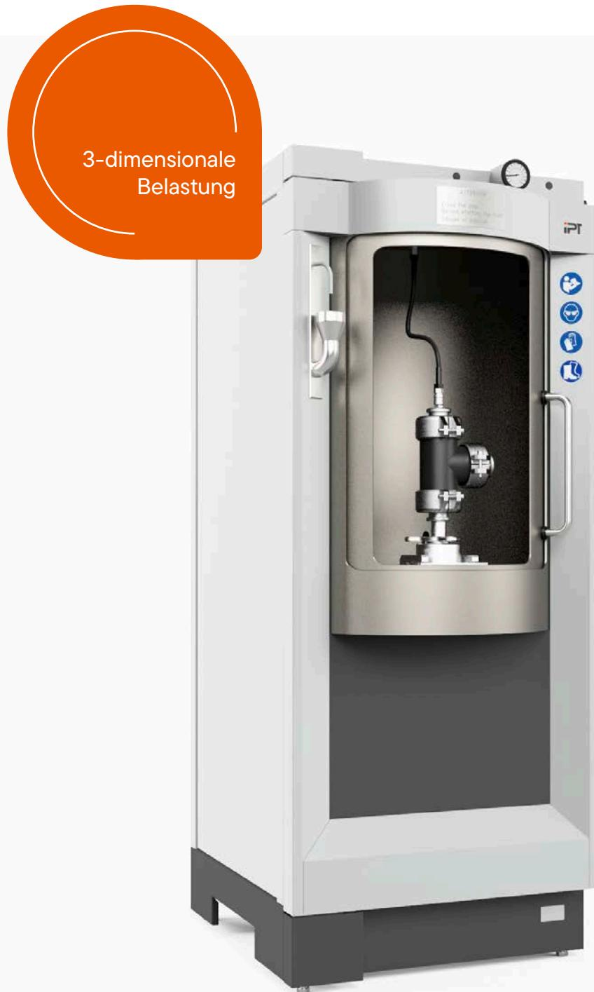
**Zuverlässiger Schutz vor Splittern während der Prüfung durch robuste Trommelkammer**
