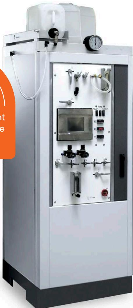
Ce testeur permet de déterminer la diffusion d'oxygène à travers les parois de tubes composites. Le testeur est constitué d'une unité d'alimentation (montée dans un bâti de l'installation), d'une étuve et d'un tambour destiné à la réception de l'échantillon (longueur :  $20 \pm 0,5$  m).
