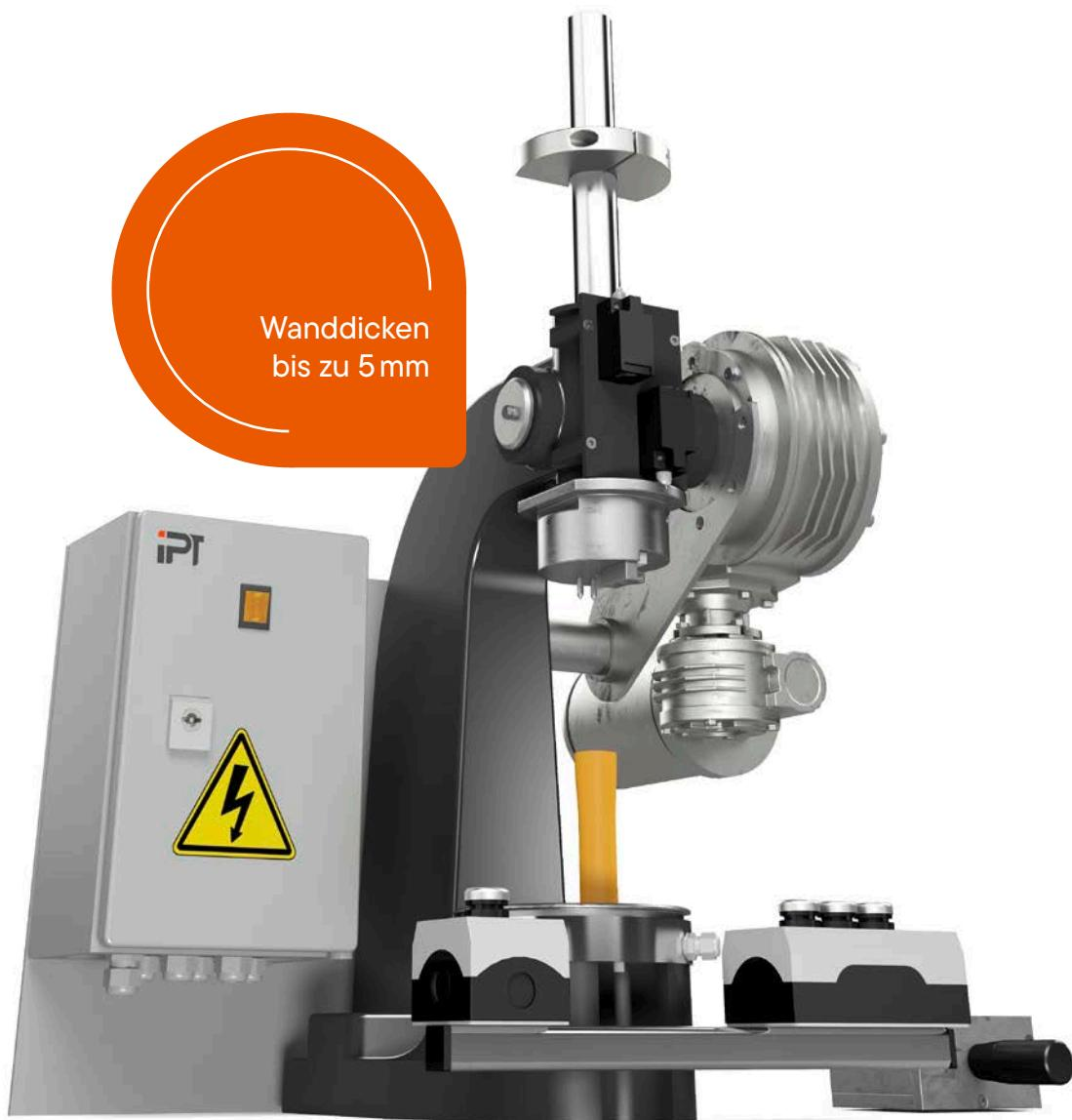
Zur Vorbereitung eines Probekörpers für die Bestimmung des Widerstandes gegenüber verzögerter Rißbildung. Der Probekörper ist ein Kunststoffrohr aus Polyethylen mit einer Wanddicke von max. 5 mm. Mit dem Prüfgerät wird in den Probekörper ein Konus eingetrieben.
