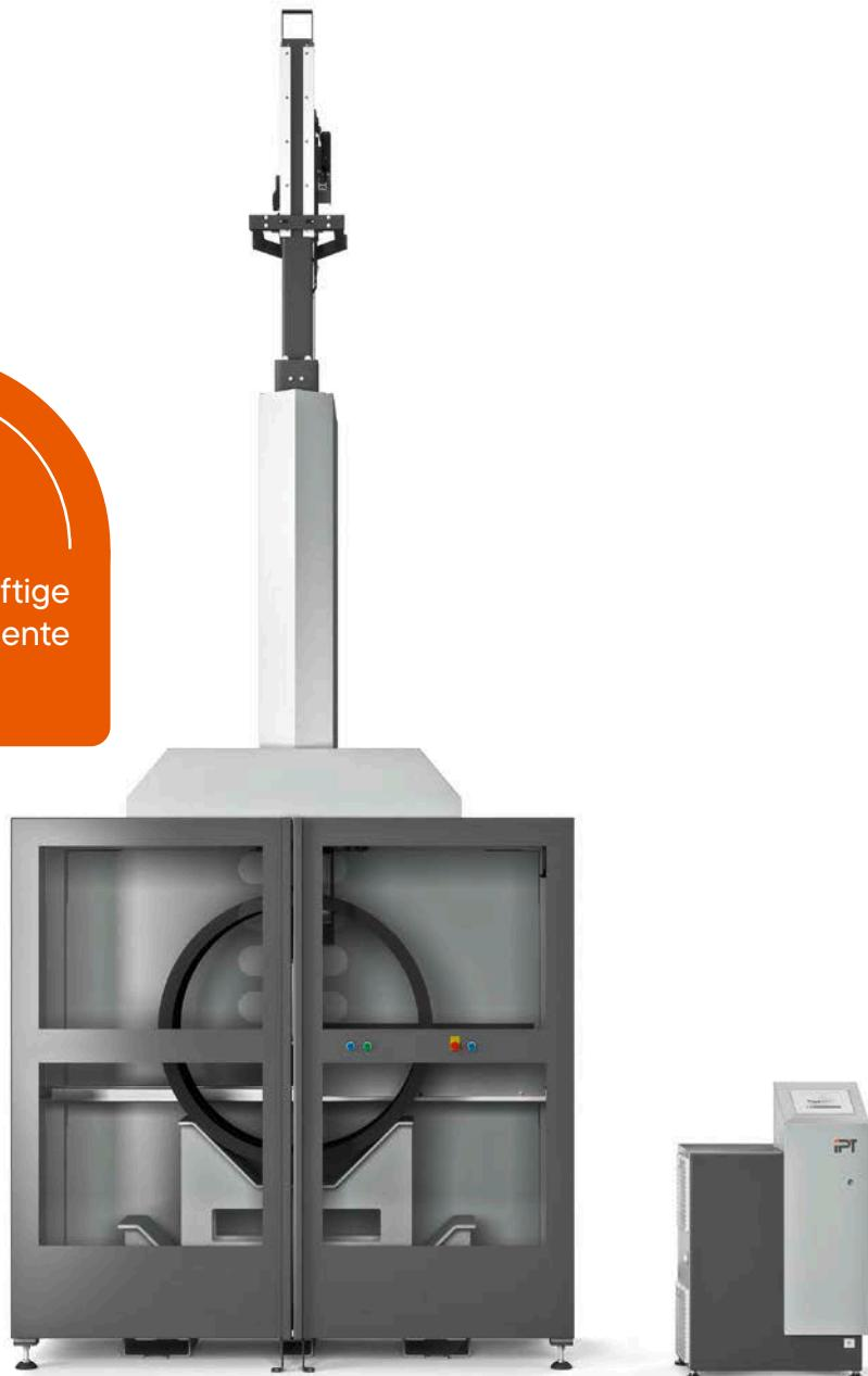
Mit dem Kugelfallprüfgerät wird die Widerstandsfähigkeit von thermoplastischen Rohren gegen äußere Schlagbeanspruchung nach der Stufen- oder Umfangsmethode bestimmt.
