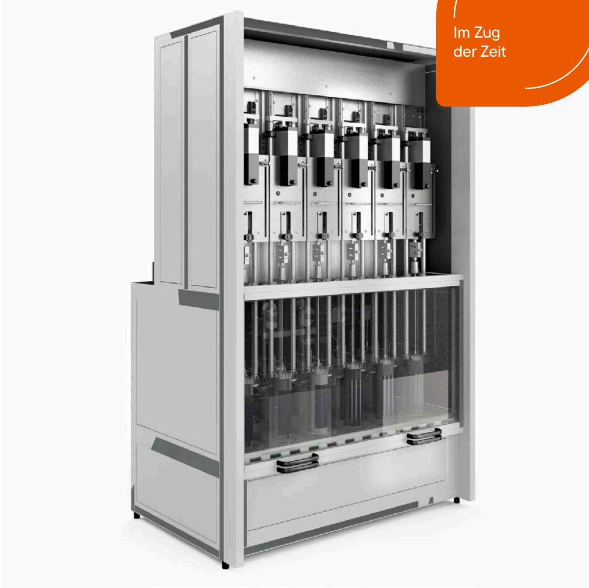
Das IPT Prüfgerät ist ein Allrounder. Es können 6 Stationen mit 6 verschiedenen Temperaturen von 40 °C (optional 20 °C) bis zu 95 °C und variablen Zugstufen bis zu 2.000 N programmiert und unabhängig voneinander betrieben werden. Die hohe Regulierungsgenauigkeit des Zugs und die Abstandsmessgenauigkeit, sowie die präzise Einhaltung der vordefinierten Temperaturen zeichnen die mikroprozessorgesteuerte Einheit aus. Jede der 6 Prüfstationen besteht aus einer unabhängigen
