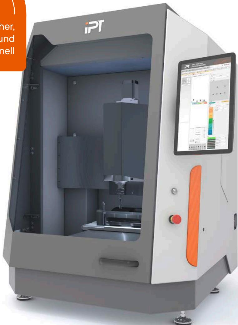
Mit der Prüfstabfräsmaschine können stabförmige Proben aus Kunststoff für Zug-, Druck-, Biege- und Schlagbiegeversuche nach den verschiedensten Normen hergestellt werden. Bei der CNC Prüfstab-Fräsmaschine handelt es sich um ein Tischgerät mit einer elektrisch verriegelten Schutztür. Durch vorprogrammierte Bearbeitungsprogramme für alle gängigen Stabformen
