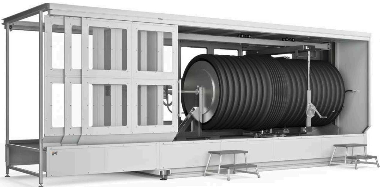
La norme ISO 13254 est une norme qui spécifie une méthode d'essai de l'étanchéité à l'eau des produits thermoplastiques pour des applications sans pression. La norme décrit comment un échantillon composé du produit à tester et d'un raccord de pièce ou de tube est soumis à une pression interne donnée, afin de contrôler l'étanchéité du raccord ou du produit.
