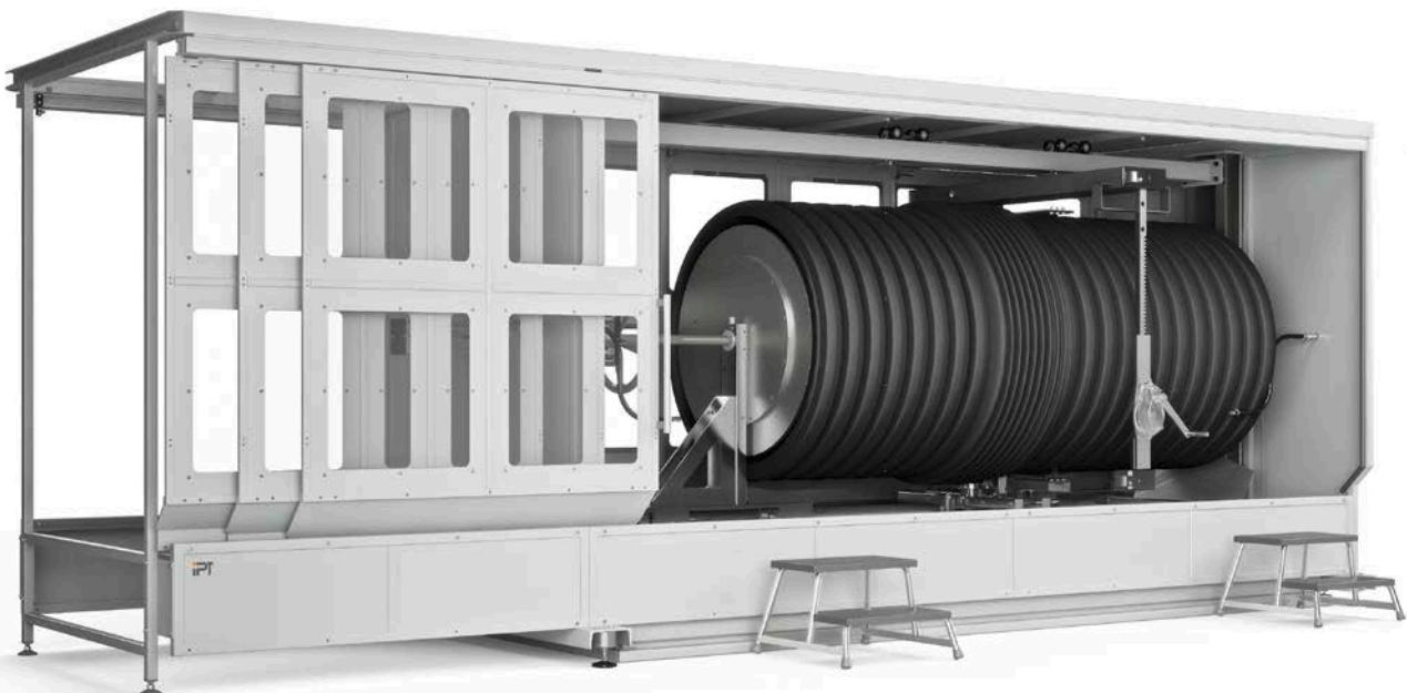
Die ISO 13254 ist eine Norm, die eine Prüfmethode für die Wasserdichtheit von Thermoplasten Produkten für drucklose Anwendungen spezifiziert. Die Norm beschreibt, wie ein Prüfmuster, bestehend aus dem zu prüfenden Produkt oder einer Rohr- und/oder Formstückverbindung, einem bestimmten Innendruck ausgesetzt wird, um die Dichtheit der Verbindung oder des Produkts zu überprüfen.
